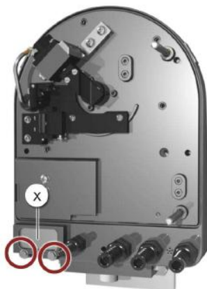
Obrázek 8-10 : Výměna filtru vzduchu
